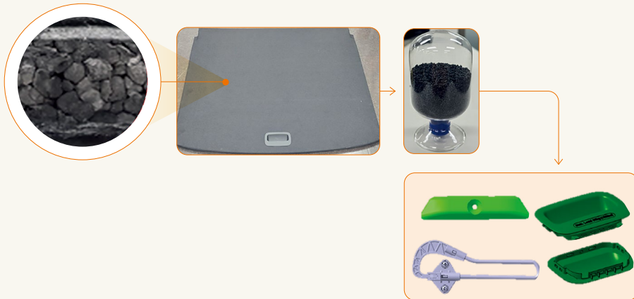
유해 폐기물인 페어망 등을 재활용한 PCR PA6(Post-Consumer Recycled Polyamide 6) 소재 개발
